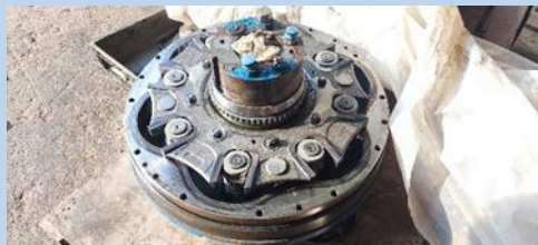
Figure 2: Desmontagem do Motor Hidráulico Häggglunds MK64
