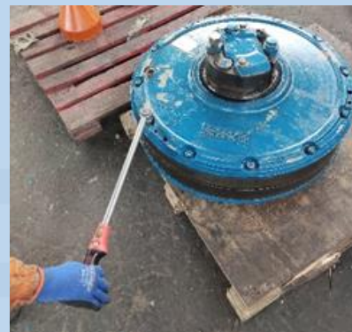
Figure 3: Aplicando Torque aos Parafusos com Chave Dinamométrica
